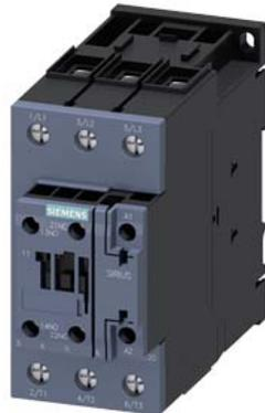
contacteur de puissance, AC-3e/AC-3, 41 A, 18,5 kW / 400 V, 3 pôles, 230 V AC, 50 Hz, contacts auxiliaires : 1 NO + 1 NF, borne à vis, taille : S2
